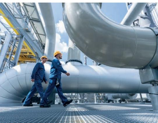
*Markant für das Verbundprinzip sind die zahlreichen Rohrleitungen. Ungefähr 2850km verlegte Rohrleitungen verbinden Anlagen und Betriebe am Standort Ludwigshafen.*
